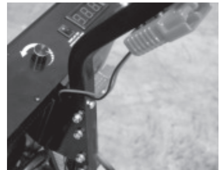
Les câbles de charge doivent passer dans les oreilles de fixation du boîtier de distribution.
