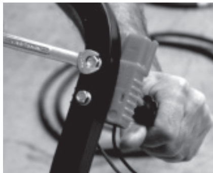
Sécuriser la connexion rapide de charge sur la poignée supérieure.
