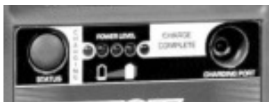
Botón de prueba, indicadores LED de carga en curso y unidad cargada
